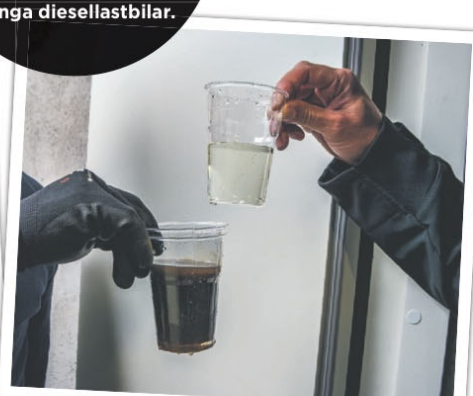
Avloppsvatten (samma färg som kaffe) blir till glasklart badvatten, efter membranet.
